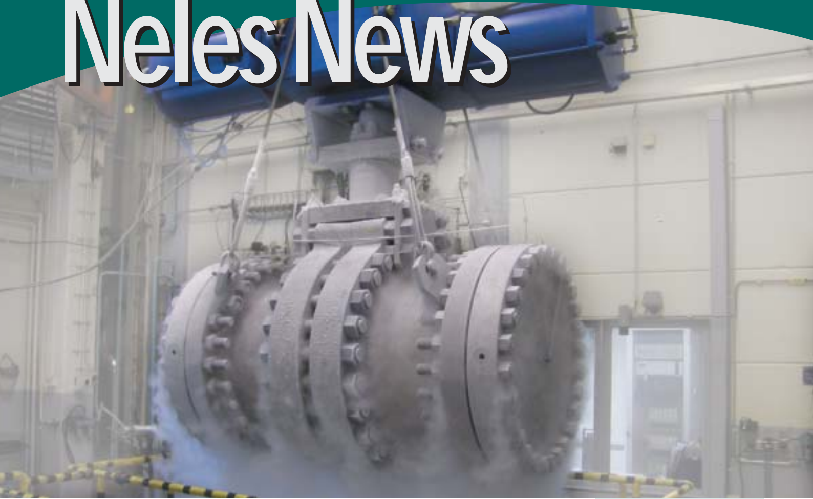
Vanne à sphère Neles ANSI 600 de 30" destinée au Train 6 de GNL du Nigeria en cours de test cryogénique (-196°C)
