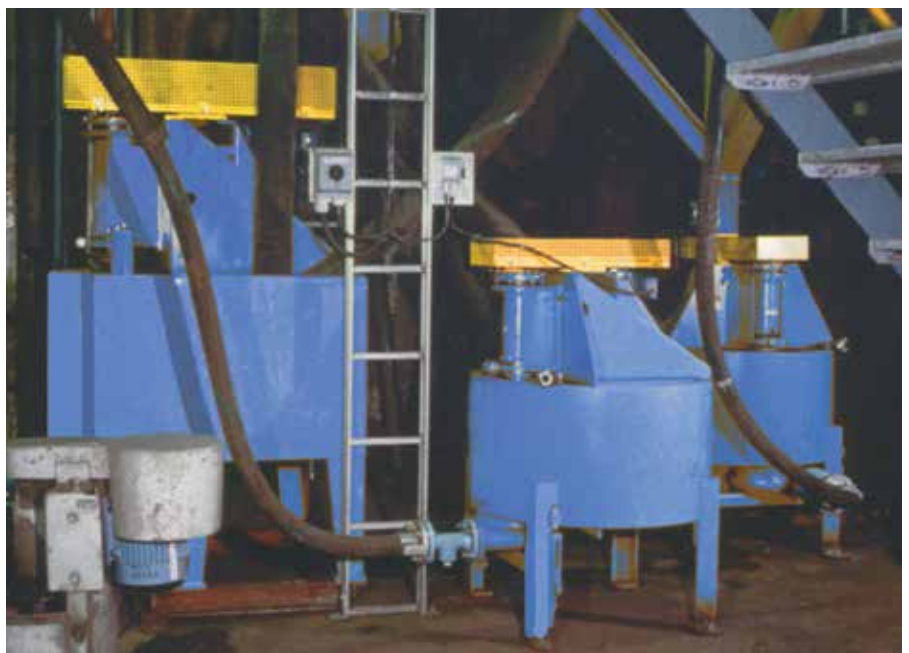
Metso VT Pumpen zum Pumpen von Konzentrat, Zwischengut und Haldenabfall von Spiralen zur Bearbeitung von Schlacken <2 mm.
